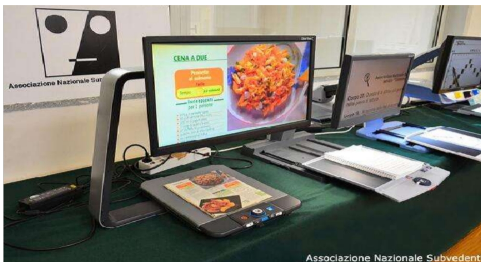
Rysunek 6: (Technologie wspomagające): Konfiguracja specjalistycznych monitorów komputerowych wyświetlających tekst i obrazy o wysokim kontraście, wraz z urządzeniem do powiększania drukowanych dokumentów dla osób z niedowidzeniem
